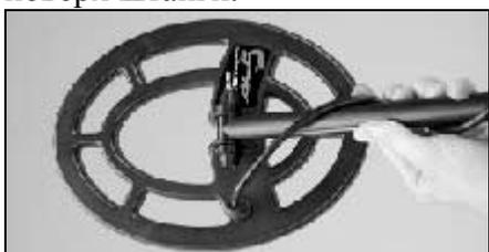
5. Вставьте штекер кабеля в разъем корпуса металлодетектора и надежно затяните его вручную.
