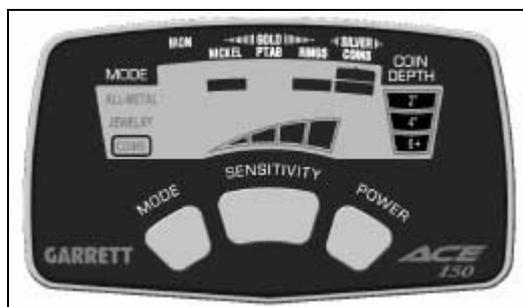
1. Кнопка **POWER (ПИТАНИЕ)** – чтобы включить (ON) или выключить (OFF) детектор, нажмите на кнопку POWER один раз. Примечание: После выключения детектора подождите 3-5 секунд, прежде чем включить прибор снова.
